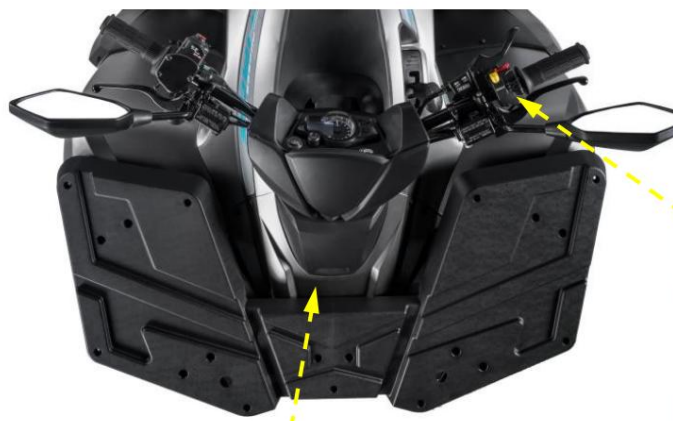
Fusibile/Batteria/Relè di avviamento
