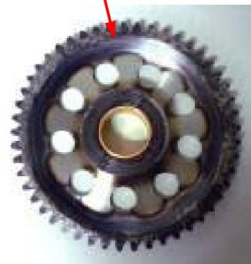
ingranaggio condotto dal motorino di avviamento
