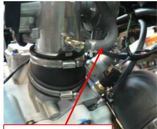
Tubo a vuoto, valvola del minimo
