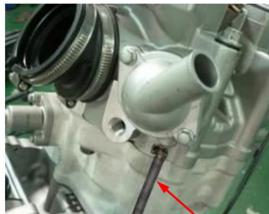
Tubo di rilascio della pressione
