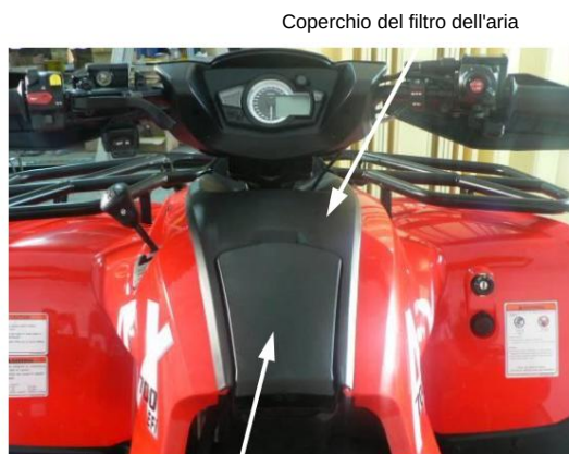
Copertura del serbatoio del carburante
