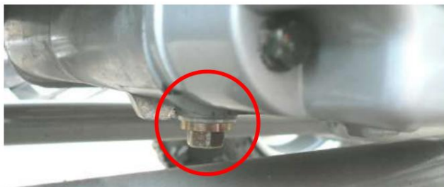
(2) Bullone di scarico dell'olio del cambio
