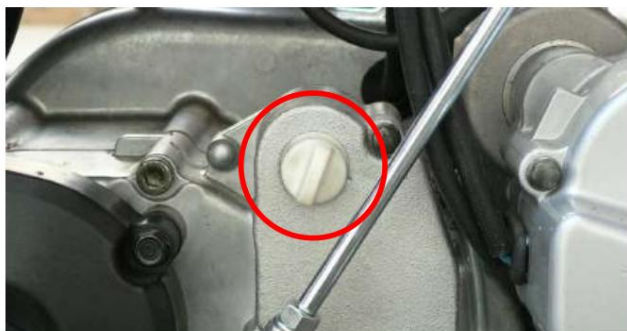
(1) Tappo di riempimento dell'olio del cambio
